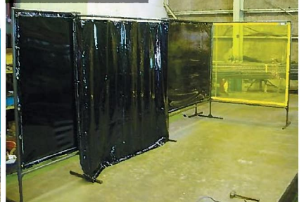
KS パネル (溶接遮光パネル)
